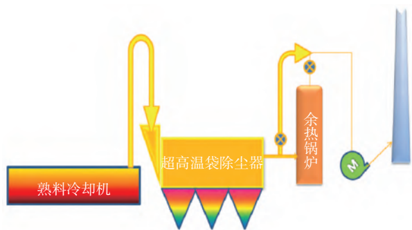
图2 电改袋后将余热锅炉后置的工艺
